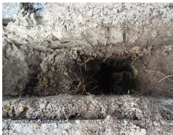
Het bomenzand bij boom 24 functioneert zoals gewenst en biedt ruimte aan intensieve beworteling. In het zand erboven nauwelijks.
