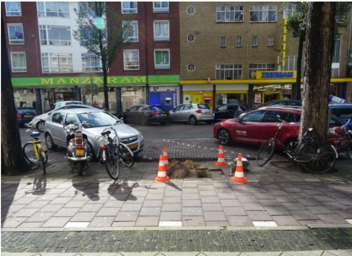
De problematiek aan de noordzijde: de bomen staan op korte onderlinge afstand en hebben tussen parkeervakken en fietspad slechts een smalle strook met bomenzand verrijkte bodem.
