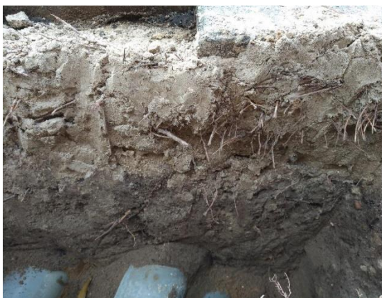
Boom 6. Het bomenzand is zwaar verdicht. De wortelgroei in het schrale straatzand erboven is intensiever dan in het bomenzand.
