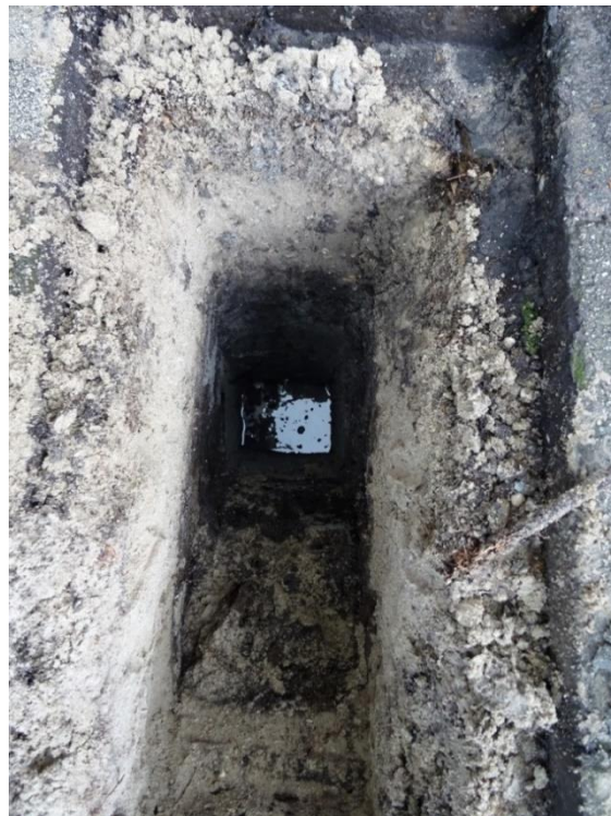
Bomenzand bij boom 48 tussen 26 en 55 cm-mv. Op 74 cm-mv is het grondwater zichtbaar.
