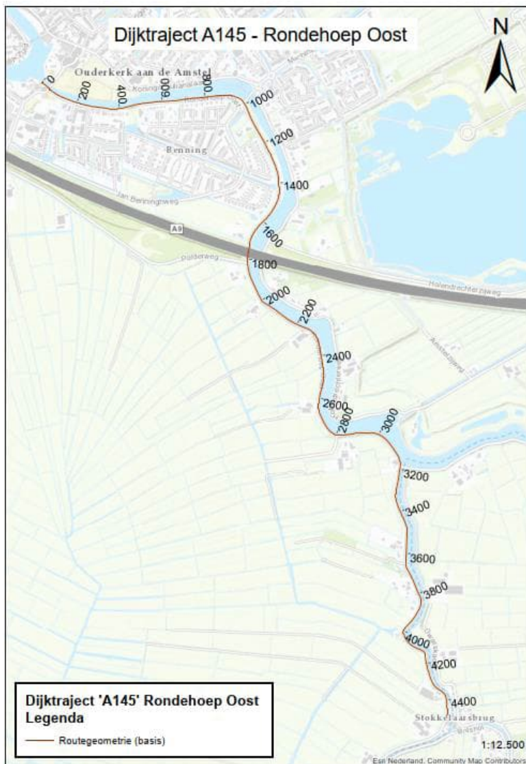
Figuur 2-1: Metrering dijktraject Rondehoep Oost
